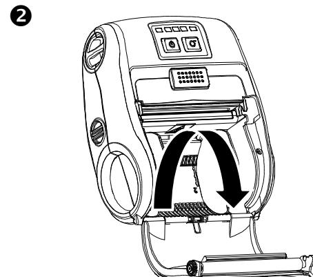
Loading Media/安装標籤/安装标签/メディアの読み込み/Загрузка носителя/ Medien werden
