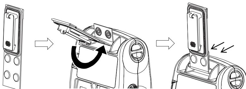
Attaching Power & Connecting Interface Cable/连接電源和傳輸線/连接电源和传输线/電源ケーブルと接続ケーブルの接続/Подключение питания и кабеля интерфейса/Anschließen der Stromversorgung und Anschließen des Schnittstellenkabels/Branchemet de l'alimentation et connexion du câble d'interface/Conexión de alimentación y conexión del cable de interfaz/Collegamento dell'alimentazione e cavo di interfaccia di collegamento/توصيل كبل الطاقة وكبل الواجهة
