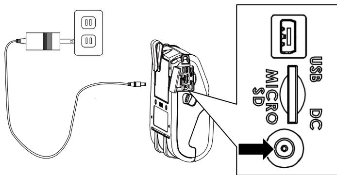
Attaching Power & Connecting Interface Cable/连接電源和傳輸線/连接电源和传输线/電源ケーブルと接続ケーブルの接続/Подключение питания и кабеля интерфейса/Anschließen der Stromversorgung und Anschließen des Schnittstellenkabels/Branchement de l'alimentation et connexion du câble d'interface/Conexión de alimentación y conexión del cable de interfaz/Collegamento dell'alimentazione e cavo di interfaccia di collegamento/توصيل كبل الطاقة وكبل الواجهة
