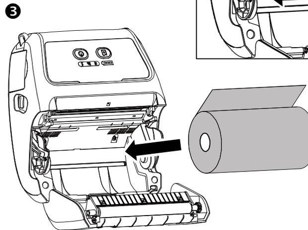
Loading Media in Peel-off Mode/剥紙模式装紙/剥紙模式装紙/ピールオフモードでのメディアのロード/Загрузка носителя в режиме отслаивания/Laden von Medien im Peel-Off-Modus/Chargement du média en mode décollage/Carga de medios en modo despegable/Caricamento dei supporti in modalità peel-off/تحميل الوسائط في وضع التقشير
