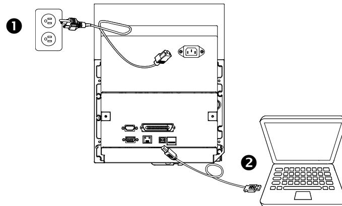
Turn on the Power/開啟電源/开启电源/電源を入れる/Включение принтера/Schalte den Strom an/Allumer l'appareil/Conectar la alimentación/Accendi il potere/
