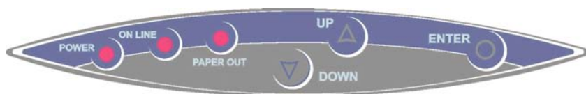
Rys. 5. Klawiatura lokalnej obsługi
