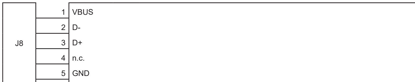
MINI USB INTERFACE Female MINI USB type B connector
