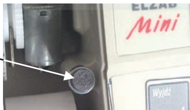
Rys. 2-8. Umieszczenie plomby serwisowej w kasie
