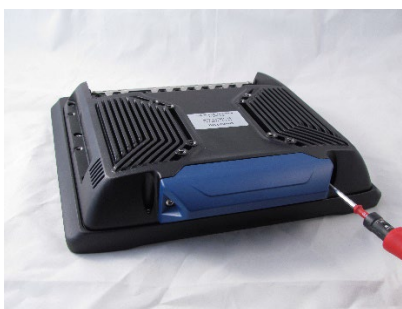
Fig. 15-2: Remove antenna cap
