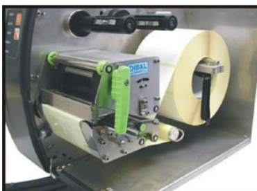
10. Zamknij głowicę (dźwignia głowicy). Drukarka jest gotowa do pracy.
