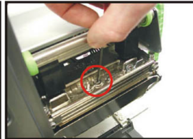
6. Zamknij dźwignię głowicy i zakręć śruby mocujące głowicę.
