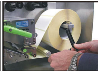
6. Załóż papier podkładowy na trzpień i zabezpiecz widełkami. Zamknij uchwyt regulacji rolki.
