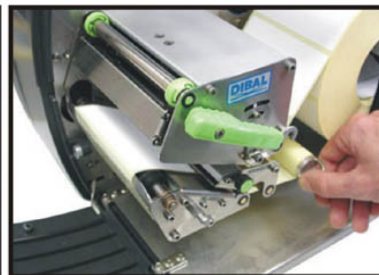
8. Obracaj trzpieniem na papier podkładowy, aż pierwsza etykieta pojawi się z przodu drukarki.
