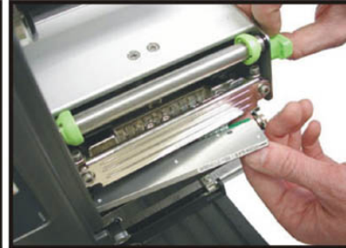
3. Podnieś dźwignię głowicy, równocześnie wyciągając głowicę.
