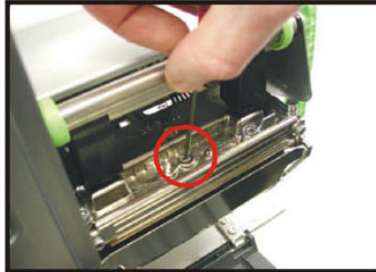
2. Odkręć śruby zabezpieczające głowicę.
