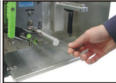
2. Wyciągnij z trzpienia widełki mocujące papier podkładowy.
