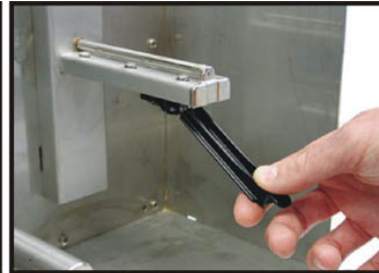
3. Pociągnij i wyprostuj uchwyt regulacji rolki papieru.
