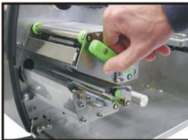
4. Podnieś gowicę, przekręcając dźwignię głowicy.
